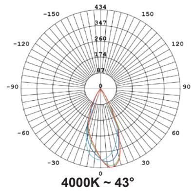
**XS - CÔNE D'INTENSITE LUMINEUSE - 230V**
