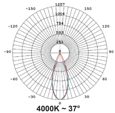
**S - CÔNE D'INTENSITE LUMINEUSE - 230V**
